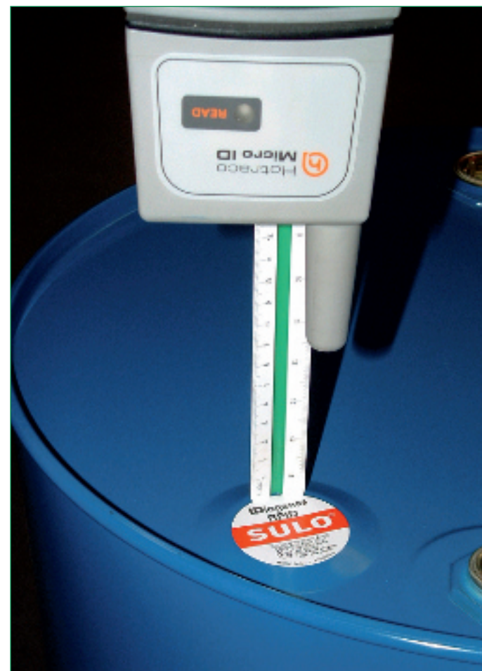
Een transponder, die met een speciale folie is omhuld, wordt gelezen met behulp van een handheld scanner. Houweling wil het leesbereik in de toekomst aanzienlijk verbeteren.
