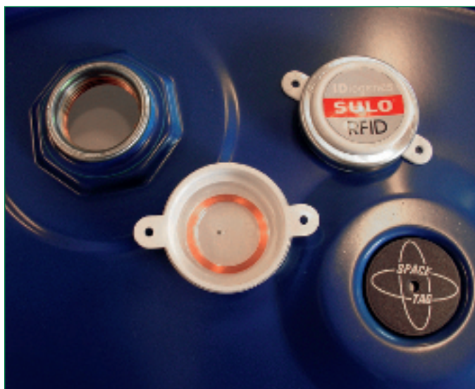
Voor het aanbrengen van de tag heeft Houweling twee mogelijkheden: de tag wordt in de verzegeling van de ventilatieopening bevestigd (links) of als herbruikbare variant met een eigen behuizing, een zogenaamde chipnest, geplaatst (rechts).
