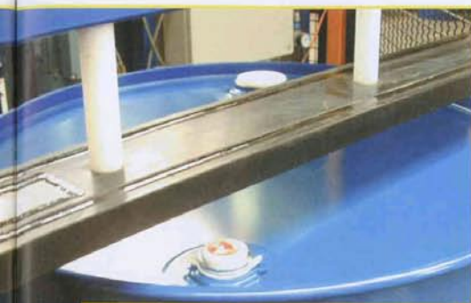
Eine fest installierte Sende-Empfangs-Einheit liest die SULO-RFID-Chips an den Fässern aus.
