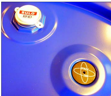
Für das Anbringen des Tags hat SULO zwei Bauarten entwickelt: Entweder es kommt in die Siegelkappe der Entlüftung (oben) oder – als Mehrweg-Variante mit eigenem Gehäuse – in ein Chipnest (unten).
