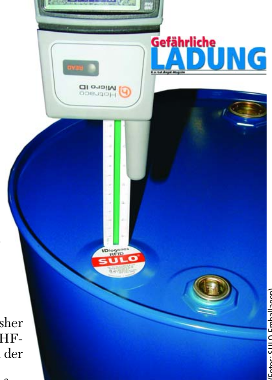
Auslesen des mit einer Spezialfolie überklebten Transponders mit einem Handheld-Gerät: SULO will die Lesereichweite künftig noch deutlich verbessern.
